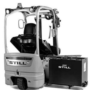
4) On-Board-Batteriebrücke für Wechsel mit Kran
