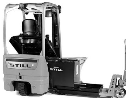
3) Wechsel mit Standard-Handgabelhubwagen, Niederhubwagen und Batteriewechselgestell
